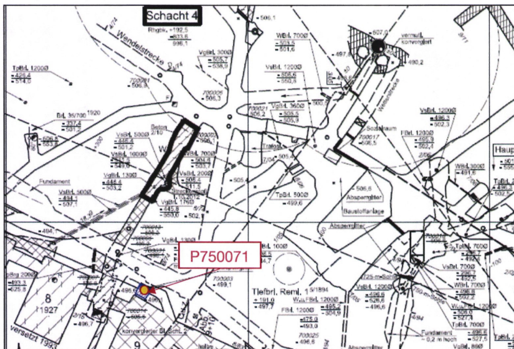
Abbildung 8.4-1: Lage der Hebestelle auf der 700-m-Sohle für die Probeentnahmestelle P750071
